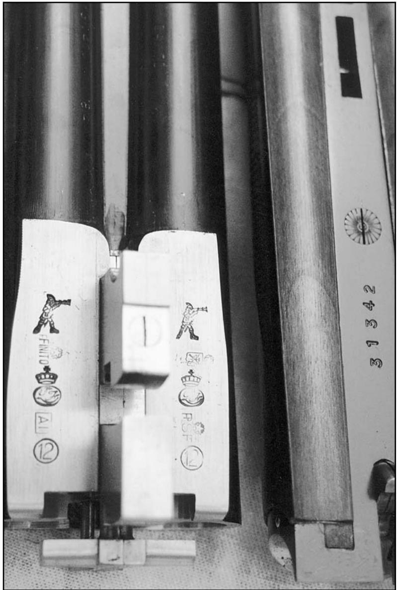
Οι κάννες του Franchi. Και εδώ έχουμε τις σφραγίδες PSF και FINITO και επίσης το 12 σε κύκλῳ που δείχνει το διαμέτρου ματιών της εταιρείας το LF σε κύκλῳ.
